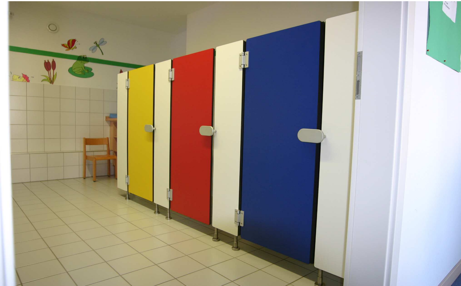
Kindergartenanlage in 13mm HPL Flächenbündig mit Fingerschutz, Türanschlagplatte in Aluminium, Aluminiumbänder, Edelstahlfüße (baugleich auch in Aluminium lieferbar) und Aluminiumwandanschlussklammern
