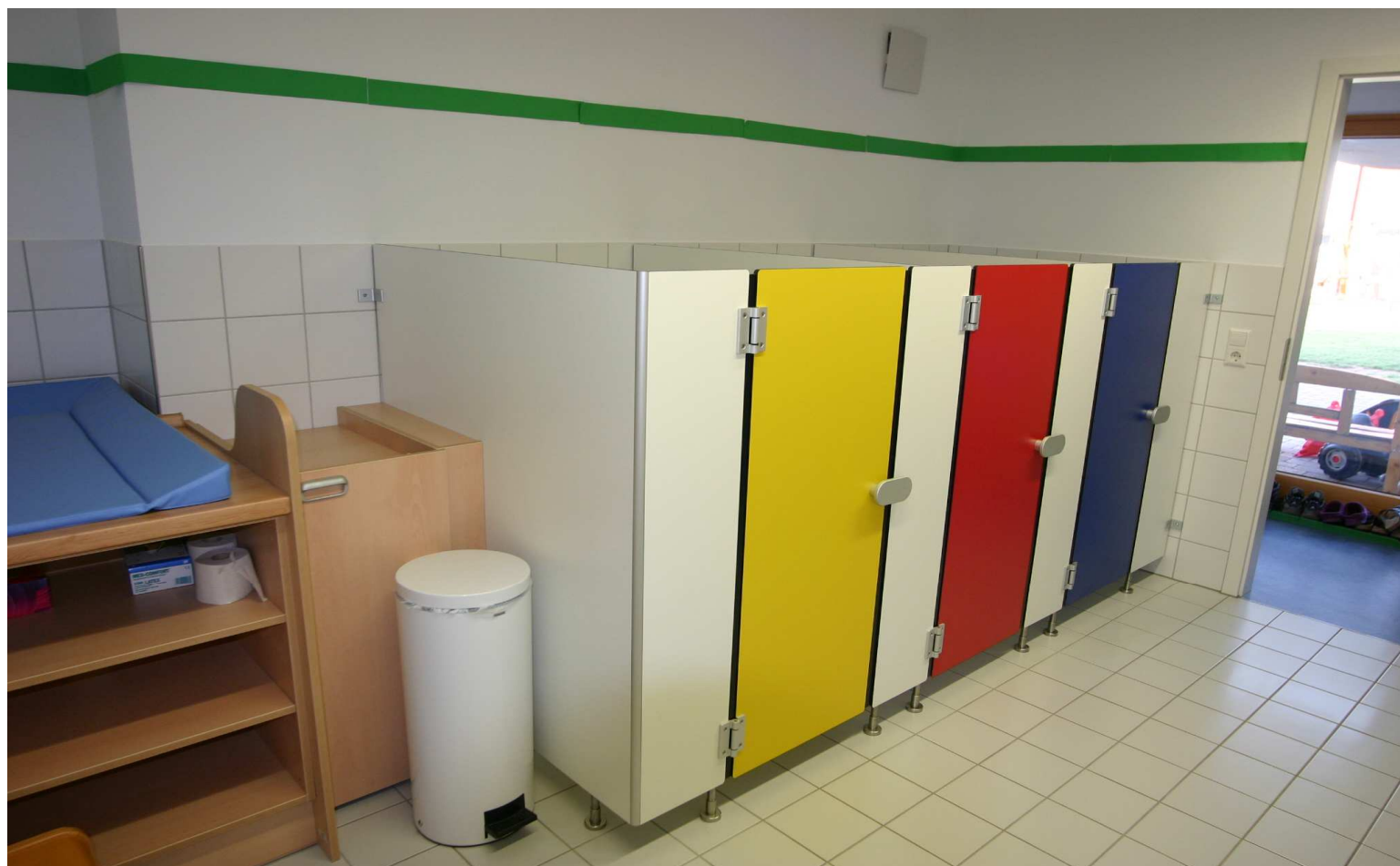
Kindergartenanlage in 13mm HPL Flächenbündig mit Fingerschutz, Türanschlagplatte in Aluminium, Aluminiumbänder, Edelstahlfüße (baugleich auch in Aluminium lieferbar) und Aluminiumwandanschlussklammern
