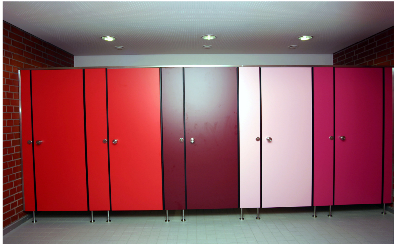
Flächenbündige 13mm HPL-Anlage mit Hartkautschuk-Türanschlägen an Bandseite als Fingerklemmschutz ausgebildet. Wandanschluss, Kopfschiene, Füße, Knopfgarnitur und Verriegelung alles aus Edelstahl.
