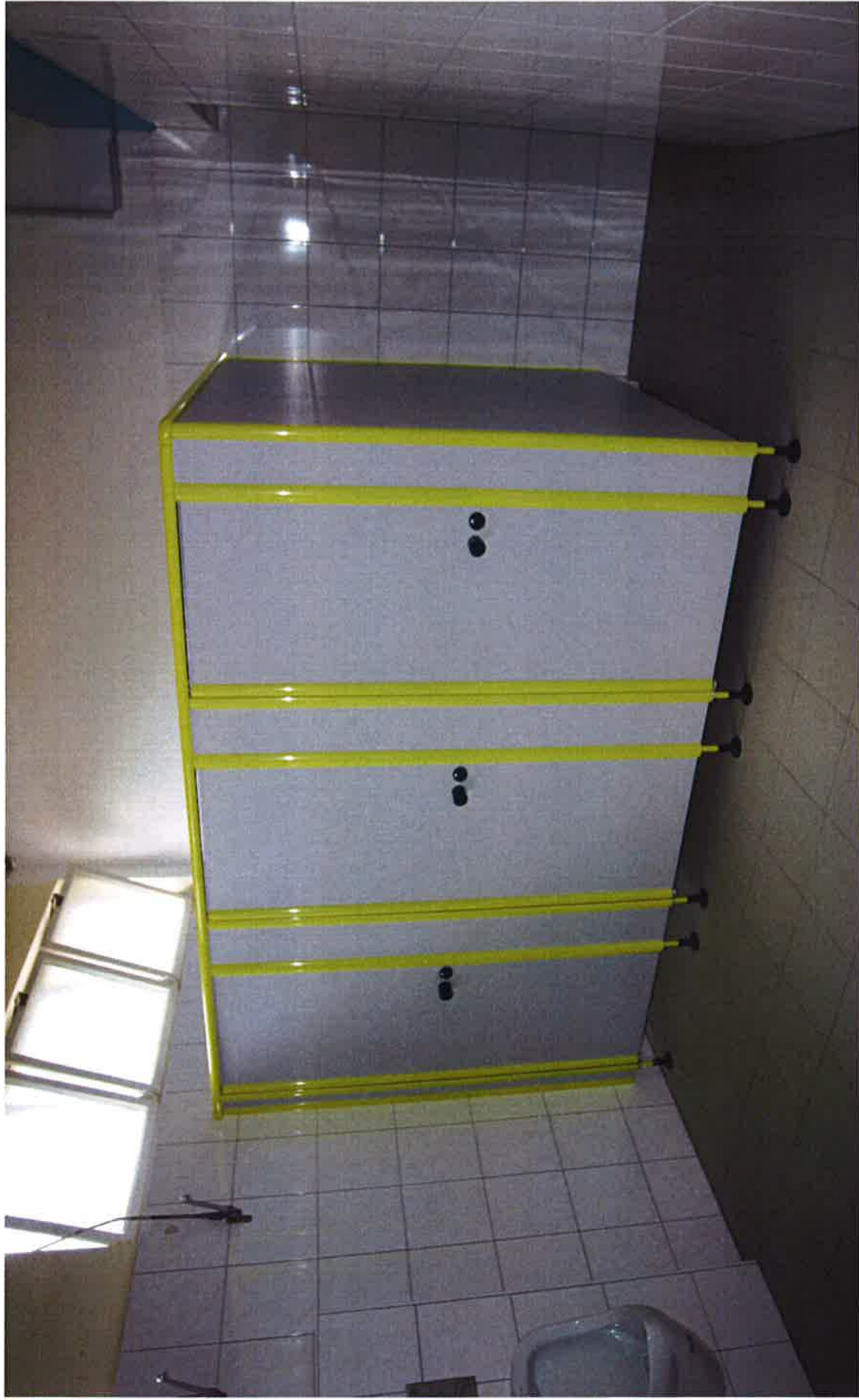
13mm HPL-Anlage mit Alu-Türanschlagprofilen, Drehzapfenband mit Fingerschutz, Nylon Knopfgehäuse und Alufüßen mit Nylonrossetten.
